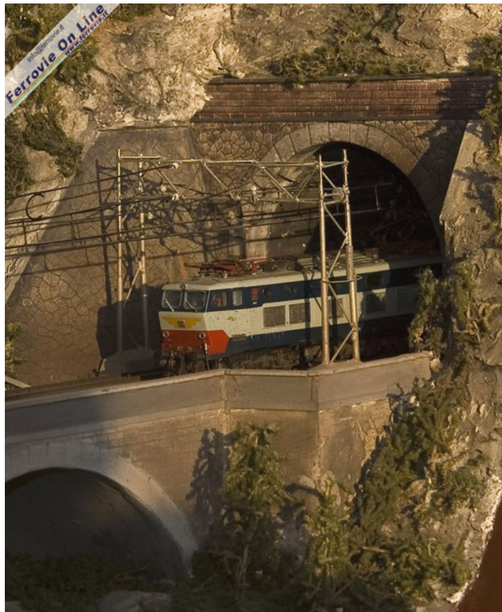
4 Dettaglio dell'uscita della galleria, con in primo piano il portale di sezionamento. Foto Alessandro Savarese
