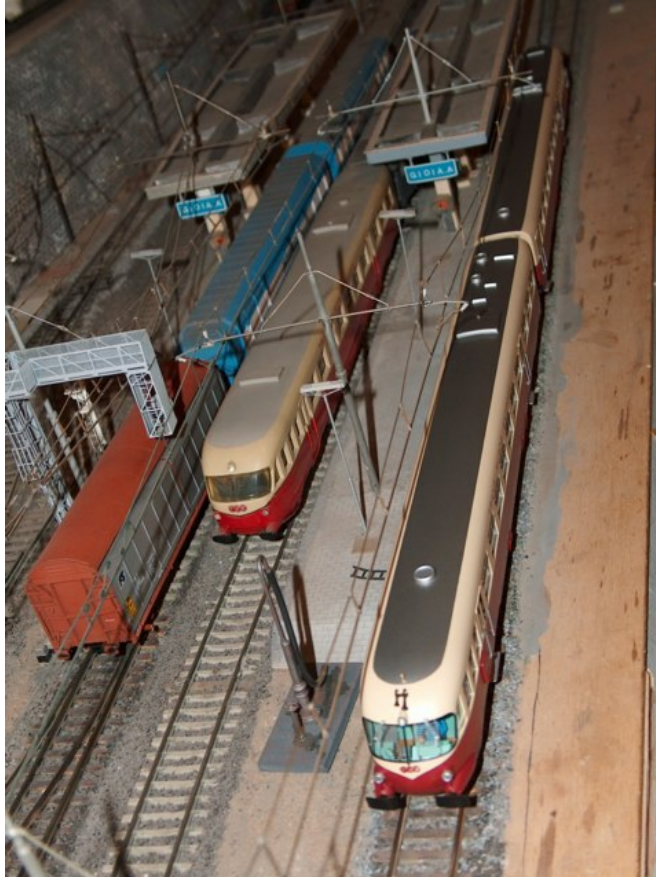
17. L'impietosa vista dall'alto mette a diretto confronto la diversa qualità dei due convogli. Anche il tetto contribuisce a distinguere la ALn 442, dotata di cucina, dalla adiacente ALn 448 caratterizzata invece dal vano bagagliaio.
