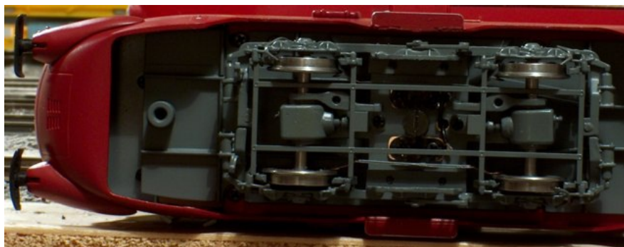
14. Vista dal basso della ALn 442.206 con il particolare del carrello, al vero motorizzato, che nel modello è destinato a prendere corrente solo dalla rotaia destra. Da notare la fine riproduzione dei ponti primario e secondario al centro di ogni asse. E' stato omissso l'albero di trasmissione del moto fra i due ponti che sarebbe stato di intralcio per l'accessibilità della vite di fissaggio del carrello. Fra il carrello e la testata si nota la sede della vite di fissaggio della barra di accoppiamento in dotazione per eventuali trazioni multiple.
