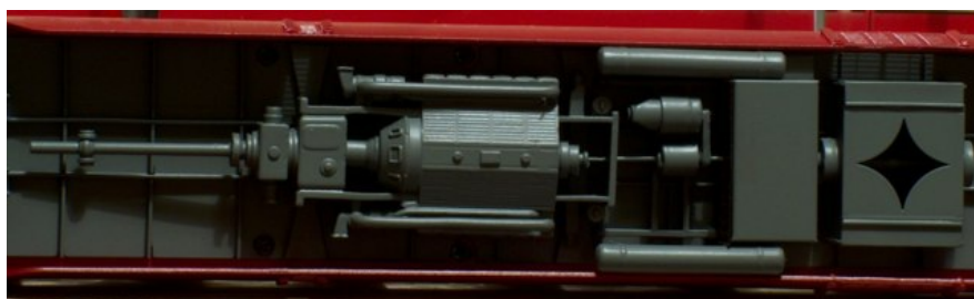
15. Al centro del sottocassa troviamo la riproduzione del motore a sogliola, vanto della tecnica italiana del dopoguerra. Alla sua sinistra possiamo notare il turbocompressore, il cambio di velocità, l'invertitore di marcia e l'albero di trasmissione verso il ponte principale sul carrello. Dall'altro lato si notano il gruppo dinamo-compressore coi relativi serbatoi cilindrici, il serbatoio di carburante ed infine ventole e canalizzazioni dell'aria verso i radiatori per la refrigerazione dell'acqua di circolazione del motore.
