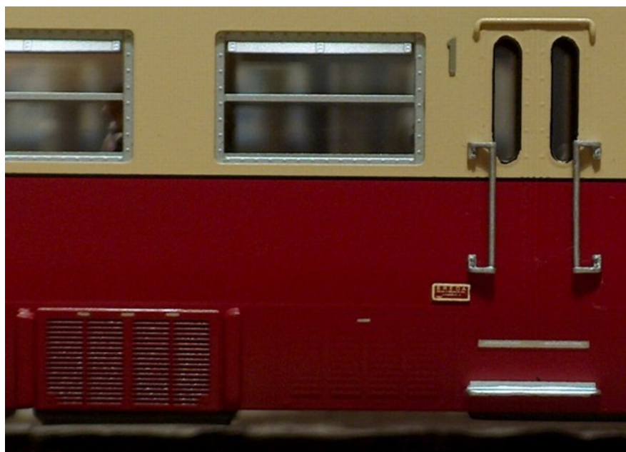
9. Un altro particolare della fiancata: da notare le bullonature sulle cornici dei finestrini, la porta di accesso con i mancorrenti riportati, le griglie nel sottocassa.
