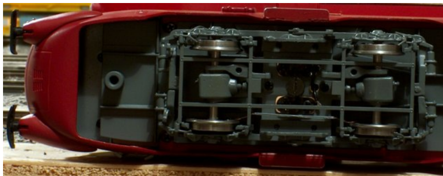
14. Vista dal basso della ALn 442.206 con il particolare del carrello, al vero motorizzato, che nel modello è destinato a prendere corrente solo dalla rotaia destra. Da notare la fine riproduzione dei ponti primario e secondario al centro di ogni asse. E' stato omesso l'albero di trasmissione del moto fra i due ponti che sarebbe stato di intralcio per l'accessibilità della vite di fissaggio del carrello. Fra il carrello e la testata si nota la sede della vite di fissaggio della barra di accoppiamento in dotazione per eventuali trazioni multiple.
