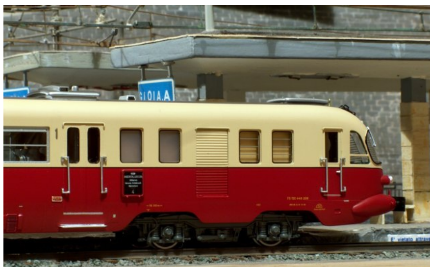
9. Un altro particolare della fiancata: da notare le bullonature sulle cornici dei finestrini, la porta di accesso con i mancorrenti riportati, le griglie nel sottocassa.
