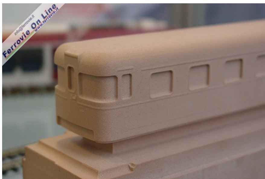
ViTrains - Altra immagine dello stampo di prova delle ALn 668 Fiat serie 1400. (Foto Fabio Veronesi)
