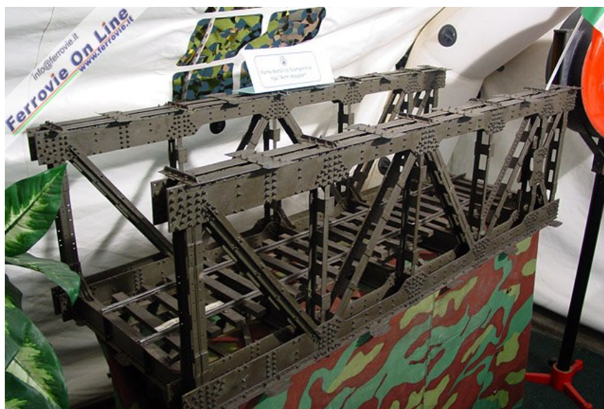
Interessanti, nello stand del Genio Ferroviario dell'Esercito Italiano, i modelli in scala di alcuni ponti utilizzati in ambito ferroviario. Qui un ponte metallico scomponibile tipo "Roth Wagner".
