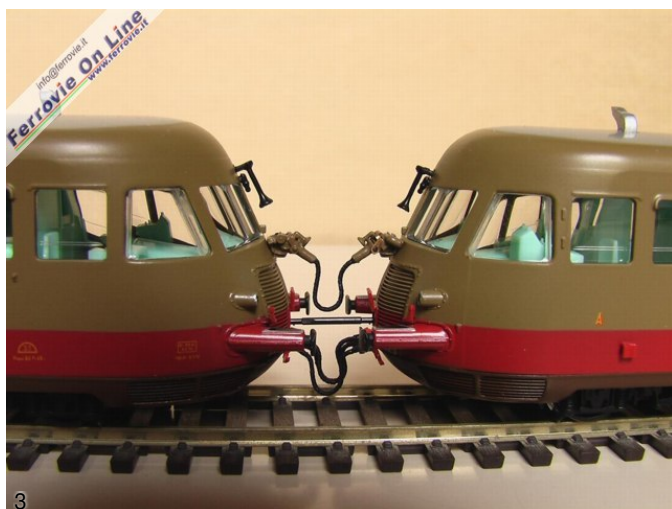
3. Il complesso sistema di accoppiamento fra due unità nella vista laterale... (Foto DUM)
