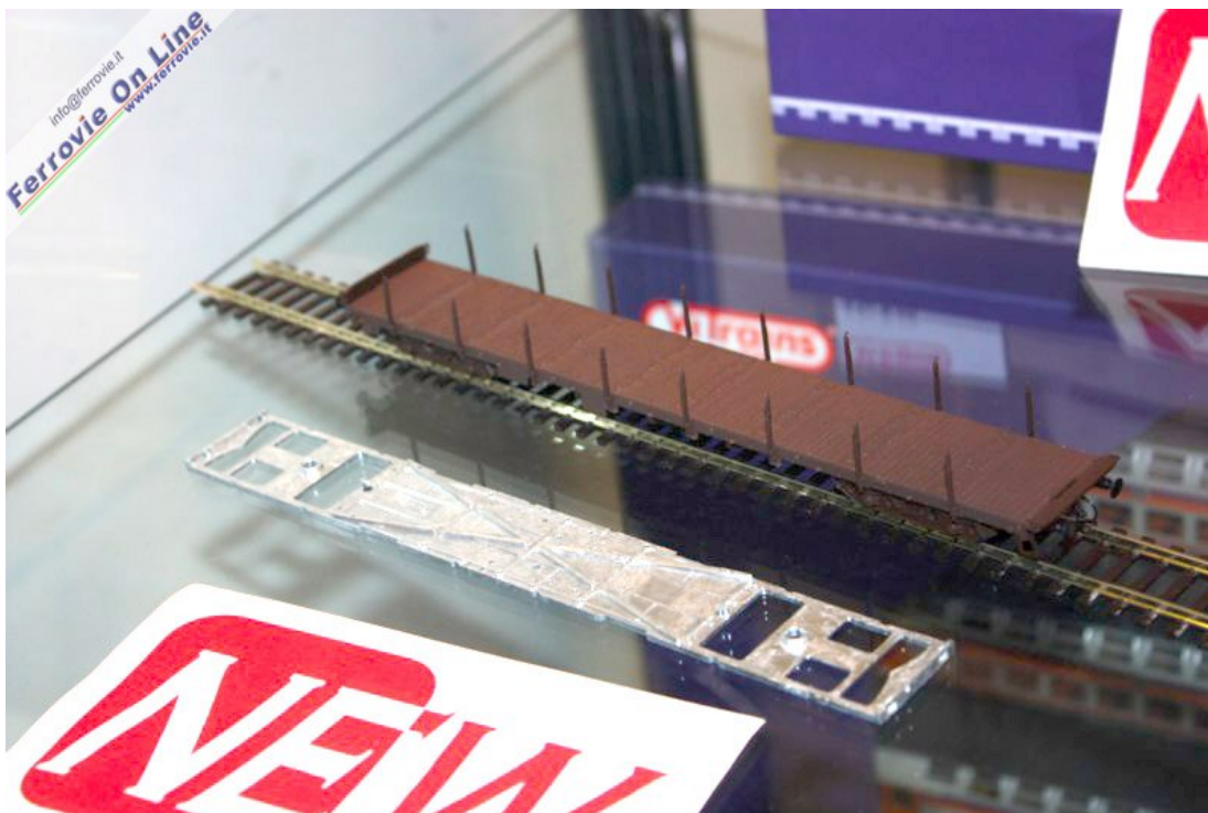
Il pianale tipo Rs caratterizzato dal telaio in pressofusione. (Foto Mario De Prisco, 27 settembre 2008)
