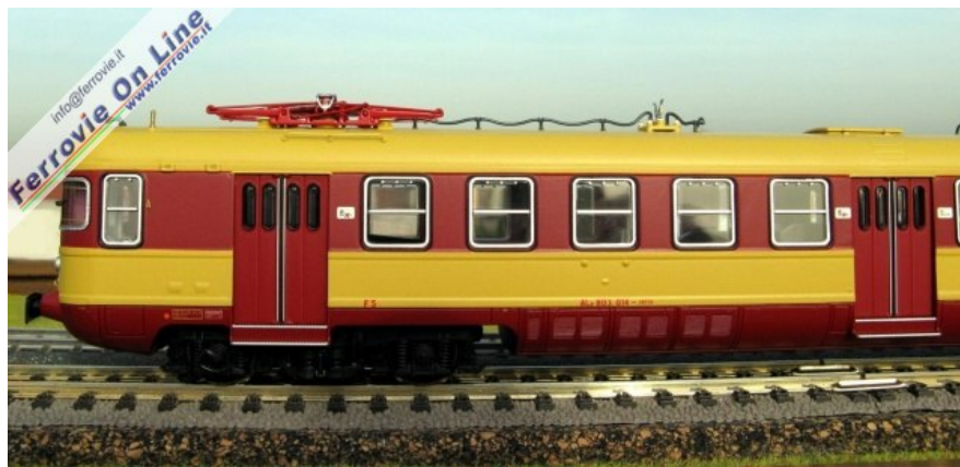
33 Particolare laterale della ALe 803 di Big Models & MdF in cui si apprezzano i nuovi pantografi tipo 52. Foto Mario di Fabio
