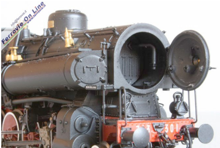
Diversamente dalla 740, lo sportello della camera a fumo è apribile e mostra una semplificata riproduzione dell'interno con la piastra tubiera appena accennata con il sistema di surriscaldamento del vapore. (Foto Mario De Prisco, 27 febbraio 2010)
