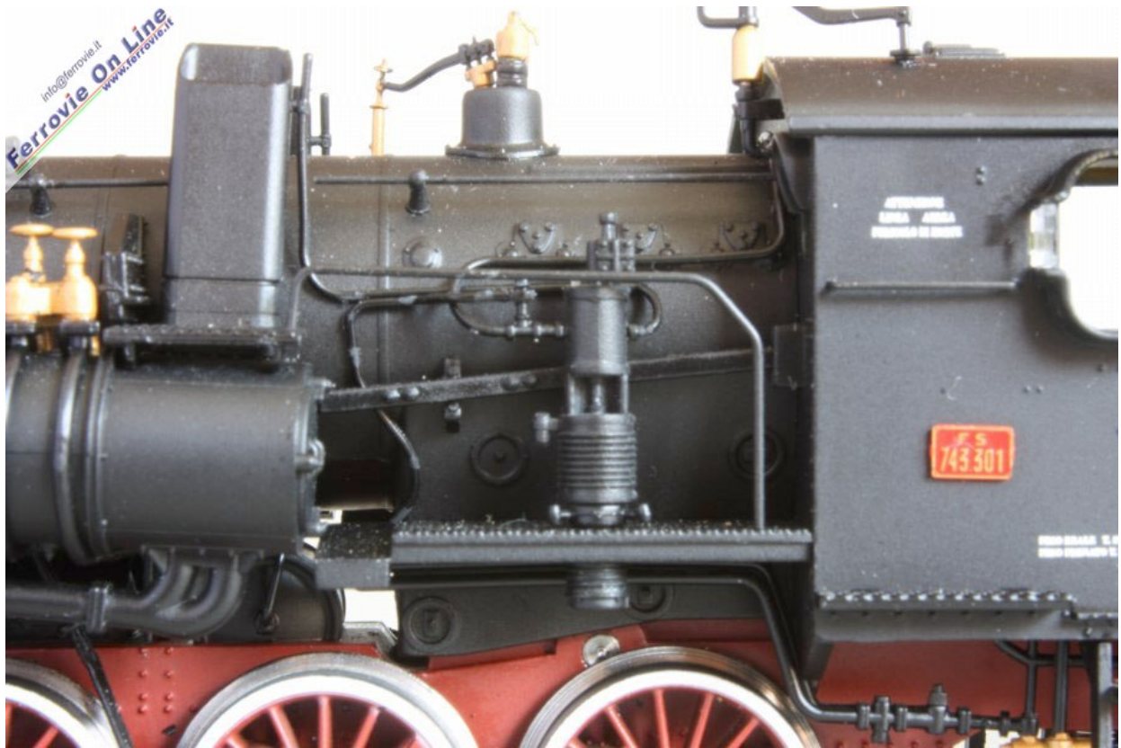
La riproduzione della pompa Westinghouse sul praticabile sinistro. (Foto Mario De Prisco, 27 febbraio 2010)
