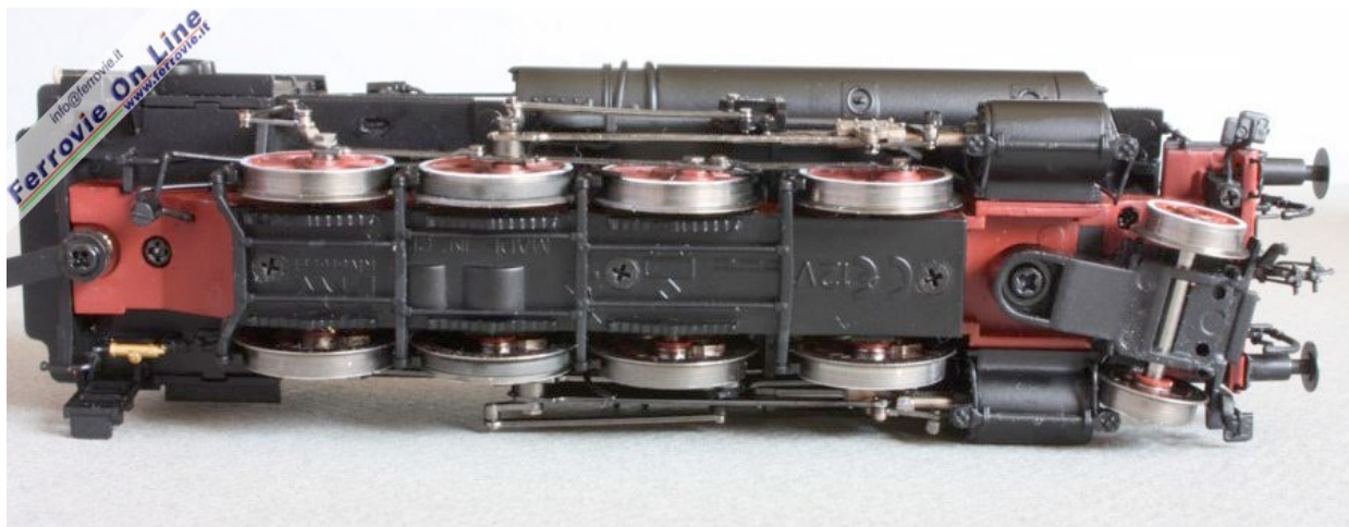
La dettagliata piastrina ferma assi con riproduzione delle balestre e delle tiranterie del sistema frenante. Per ovvia semplificazione costruttiva l'asse portante è come al solito realizzato in forma di bissel. (Foto Mario De Prisco, 27 febbraio 2010)
