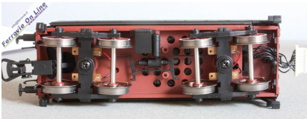
Vista inferiore del tender: spiccano i fori in corrispondenza dell'altoparlante del sistema sonoro, ma anche l'abbozzo del sistema frenante ed il timone di allontanamento per il gancio lato treno. (Foto Mario De Prisco, 27 febbraio 2010)
