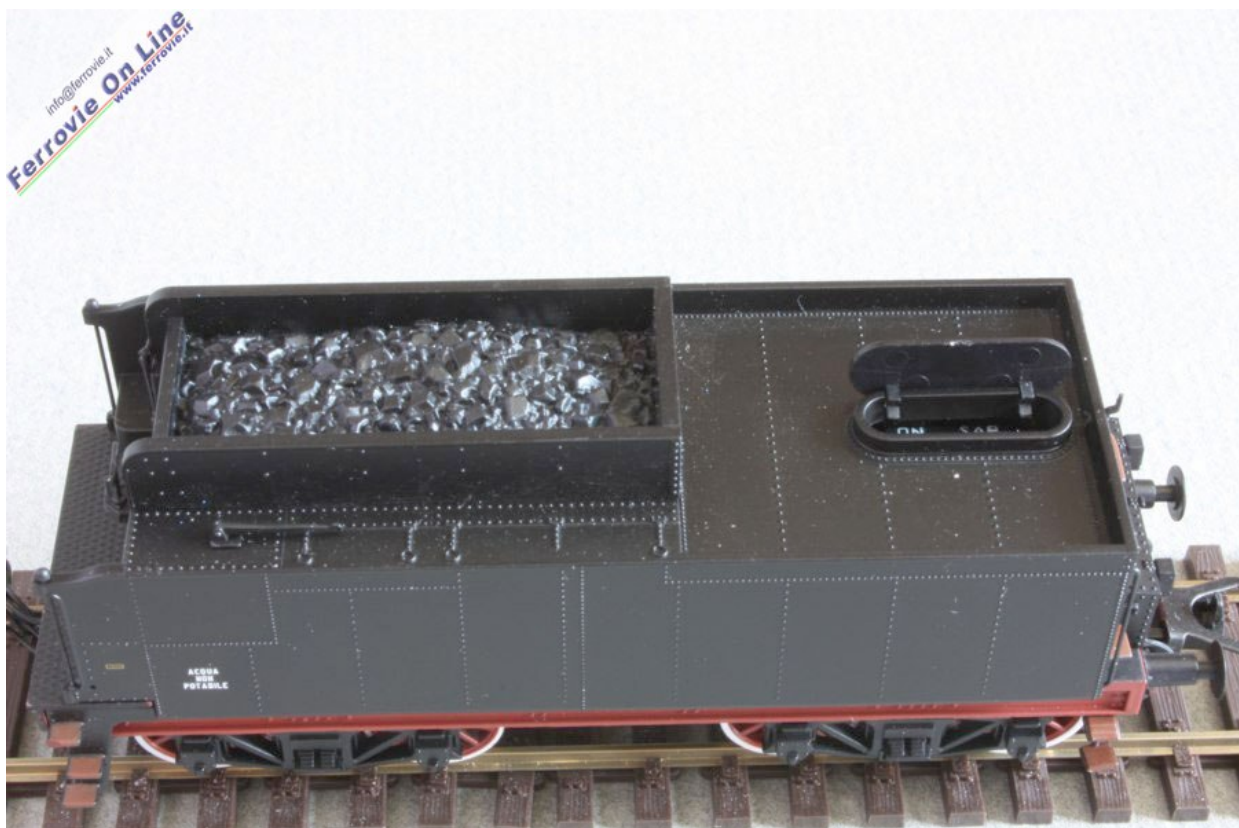
Il tender, lo stesso della 740, ha perso il discusso sopralzo della carboniera e presenta il boccaporto per il carico dell'acqua realmente apribile per accedere ai micro interruttori per selezionare il tipo di illuminazione gradita dal modellista. (Foto Mario De Prisco, 27 febbraio 2010)
