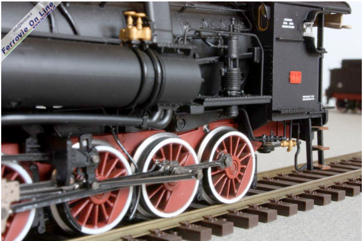
Un particolare del rodiggio e del biellismo, completamente rinnovati rispetto alla 740. Foto Mario De Prisco, 27 febbraio 2010
