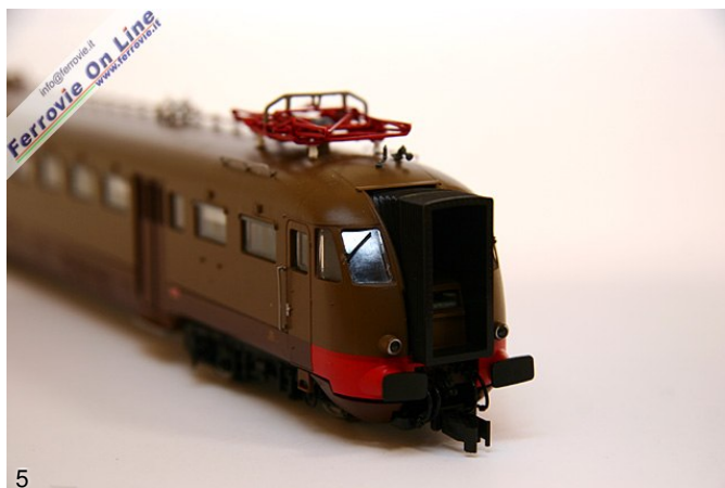
5. Frontale della ALe 840 con intercomunicante aperto. All'interno del mantice si riconosce l'interruttore per la gestione dei fanali sottostanti. (Foto David Campione)
