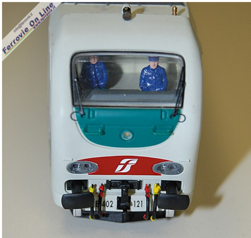
1. Frontale della E.402.121. Spiccano i tergicristallo in metallo e l'interno della cabina ben visibile attraverso l'ampio vetro frontale. (Foto Rivarossi)
