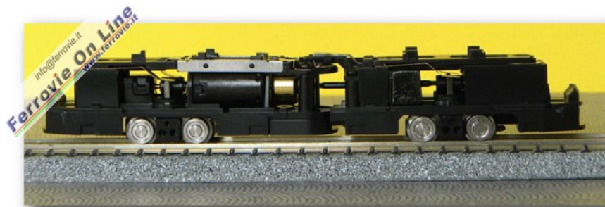
Telaio motorizzato per i tram di Tomix. (Foto Tomix)
