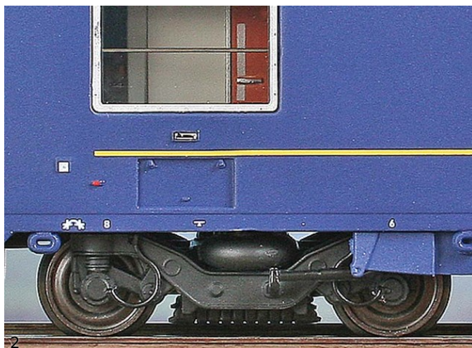
2 Il carrello Y32P riprodotto con la sospensione in gomma. (Foto Acme)
