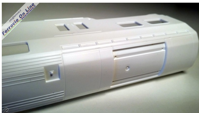
2. Particolare del tetto con la cannellatura che contraddistingue le carrozze Vivalto della seconda serie. (Foto Ferrovie.it)
