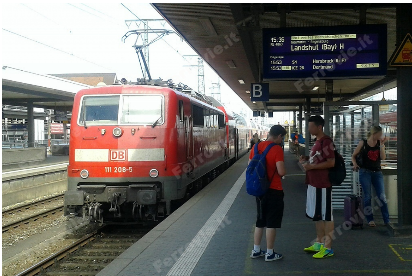
61. A Nürnberg Hbf il RE 4863 per Landshut sta per partire spinto dalla 111 208, costruita da Henschel a Kassel (con parte elettrica BBC) nel 1983. (foto Jacopo Fioravanti, 28 agosto 2016)
