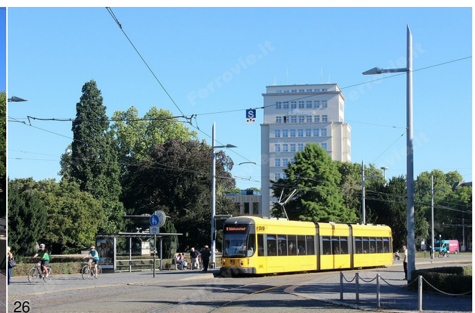
23. Dresda possiede una notevole rete tranviaria (12 linee, oltre 130 km di sviluppo complessivo) a scartamento 1 450 mm. Qui vediamo la vettura 2611, un NGT D8DD Bombardier costruito a Bautzen nel 2007, mentre lascia Theaterplatz per avviarsi verso la Augustusbrücke, in servizio sulla linea 9. (Foto Jacopo Fioravanti, 26 agosto 2016)
