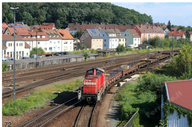
70. La stazione di Schwandorf vede anche un discreto traffico merci; sui binari del fascio si avvicendano nelle manovre le due locomotive Diesel-idrauliche DB 294 648 e 294 750, costruite da MaK a Kiel nel 1968 e nel 1972 rispettivamente. Sullo sfondo, seminascode dai carri, due "Ludmilla" gruppo 232, purtroppo spente e immobili in quella posizione. (Foto Jacopo Fioravanti, 29 agosto 2016)
