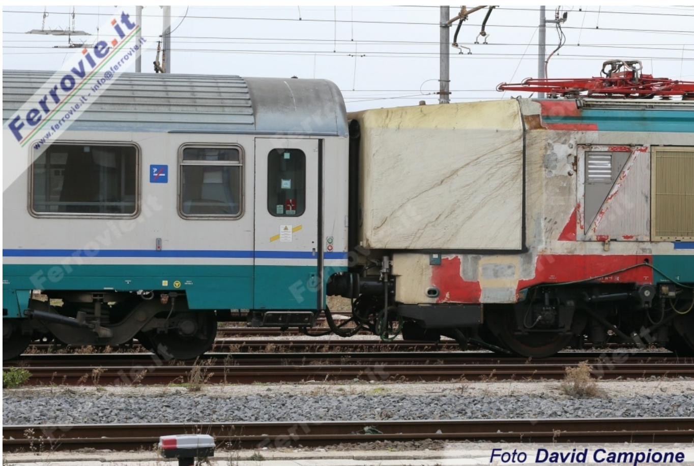
3 a Particolare dell'accoppiamento lato intercomunicante tra la E.401.013 ed una UIC-Z. Risalta la diversa sagoma tra il modulo aggiunto sulla locomotiva al posto della cabina e la carrozza adiacente. (Foto David Campione, 16 gennaio 2017)
