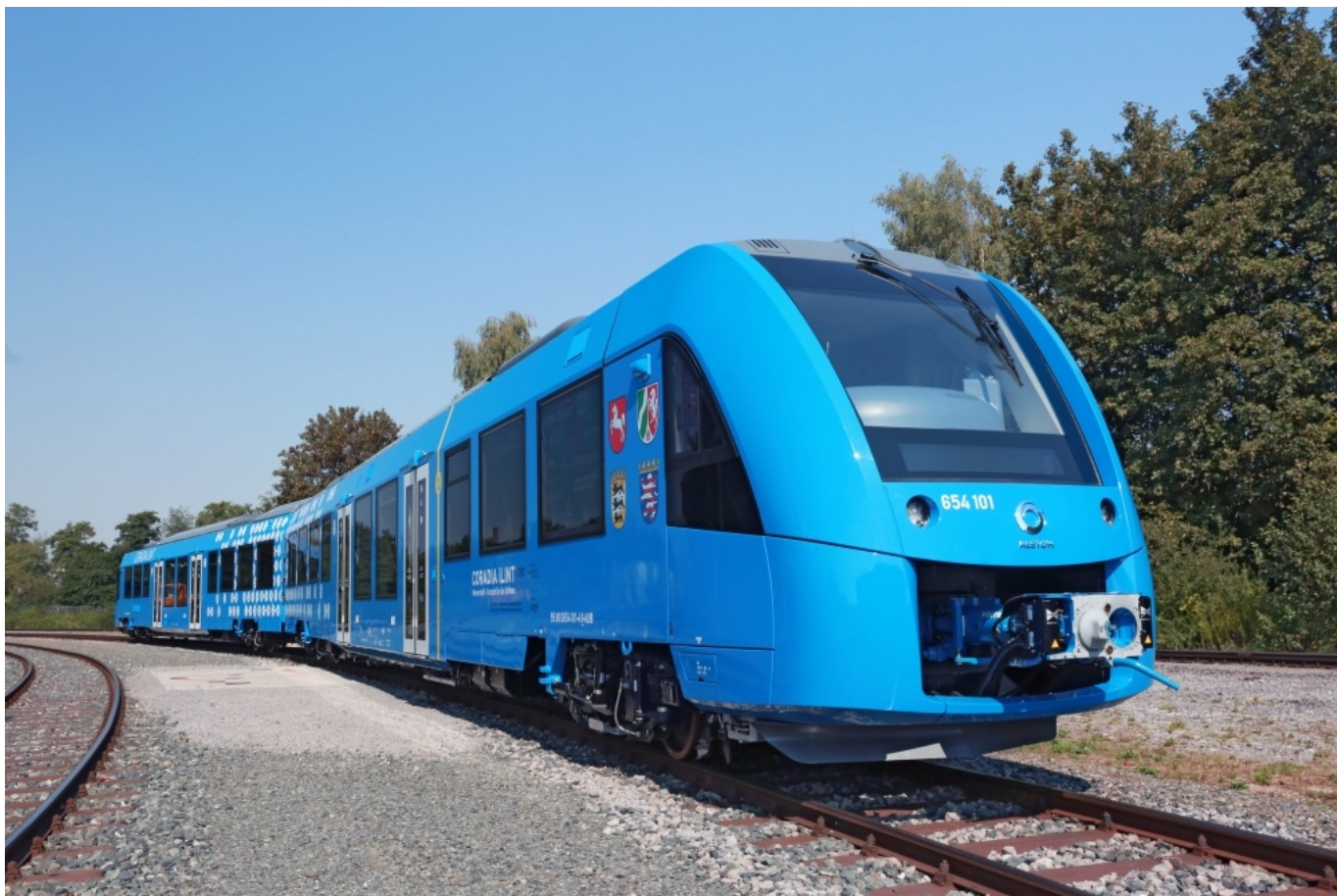
Il Coradia iLint di Alstom, prima automotrice al mondo alimentata a idrogeno, sul circuito di prova di Salzgitter. (Foto © Alstom, 14 marzo 2017)
