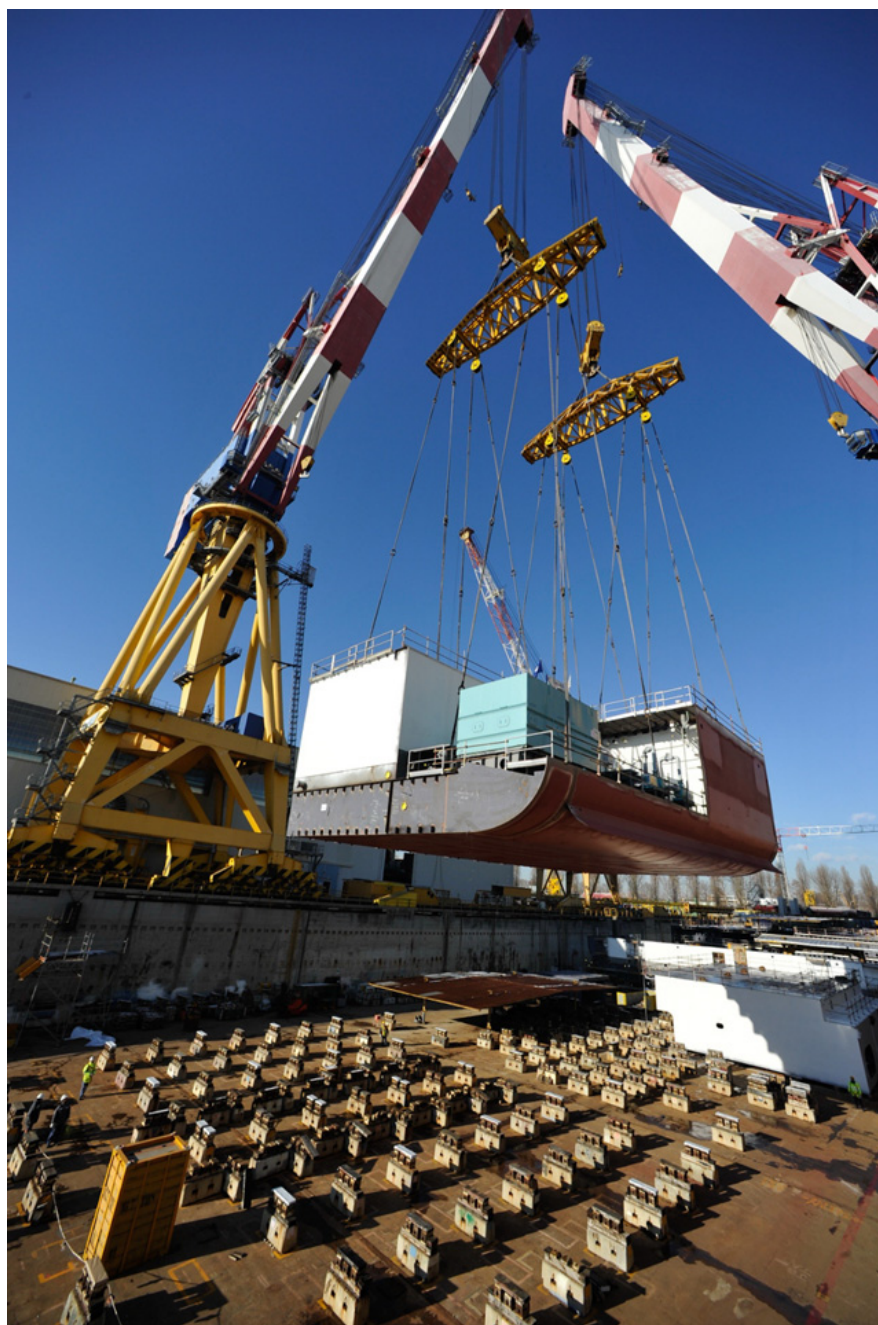
3. La discesa del primo blocco sugli zoccoli in legno che lo sosterranno durante la lavorazione e la saldatura agli altri blocchi di nave. (Foto Fincantieri, 10 dicembre 2012)
