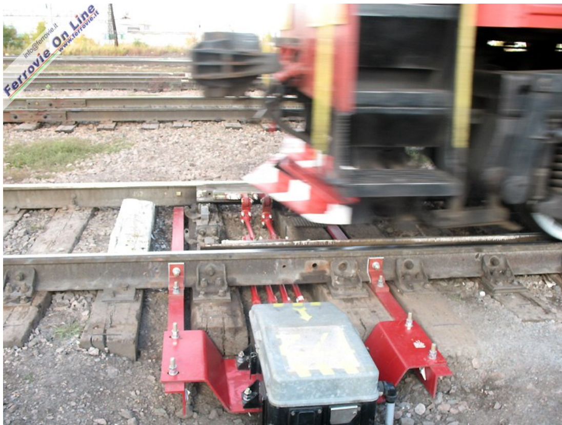
1 1 La cassa di manovra Alstom già in opera sperimentalmente presso la stazione di Astana. (Foto Alstom)
