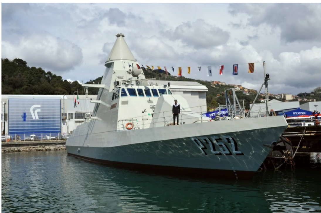
2. I pattugliatori "Ghantut" e "Salahah", lunghi 55 metri, larghi 8,60, possono superare i 20 nodi di velocità e ospitare a bordo un equipaggio di 28 persone. Foto Fincantieri, 22 aprile 2013
