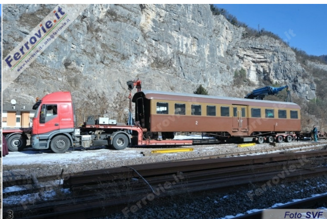
3. La "Corbellini" Bz 38.416 mentre viene scaricata tramite rampa mobile da un rimorchio stradale. (Foto SVF)
