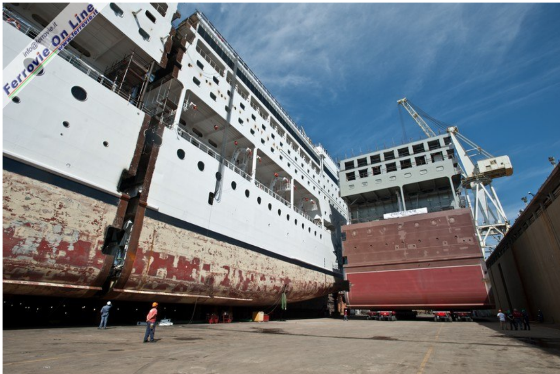
3. Il modulo di 24 metri pronto per l'inserimento nel taglio di Armonia, che avverrà dopo aver traslato in avanti la parte anteriore dello scafo. (Foto Fincantieri, 10 settembre 2014)
