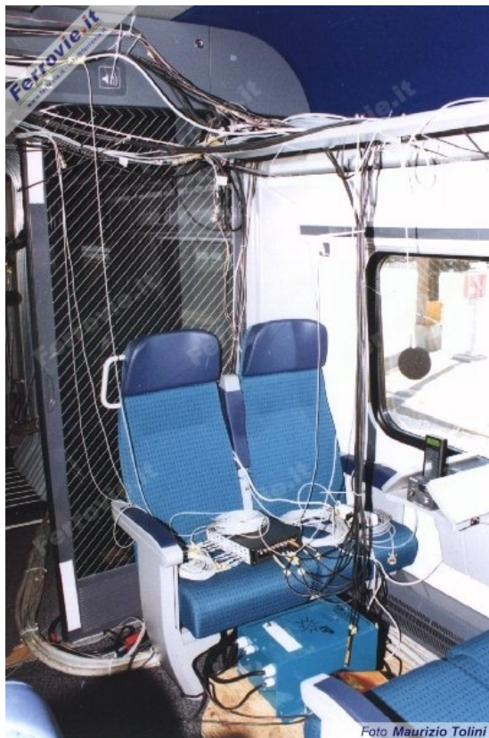
3. L'interno del treno colmo di apparecchiature e cavi necessari per la raccolta dei dati durante le corse prova. (Foto Maurizio Tolini, Gennaio 1999)
