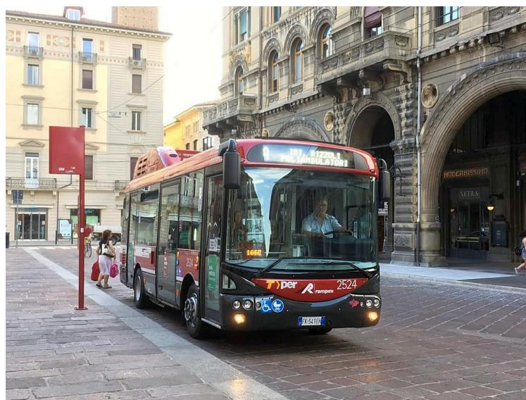
Gli otto nuovi mezzi sono, infatti, autobus di ridotte dimensioni, particolarmente adatti per l'utilizzo sulle linee-navetta urbane. Si tratta di mezzi dotati di climatizzazione integrale e di pedana d'accesso e posto attrezzato per passeggeri su carrozzina.
