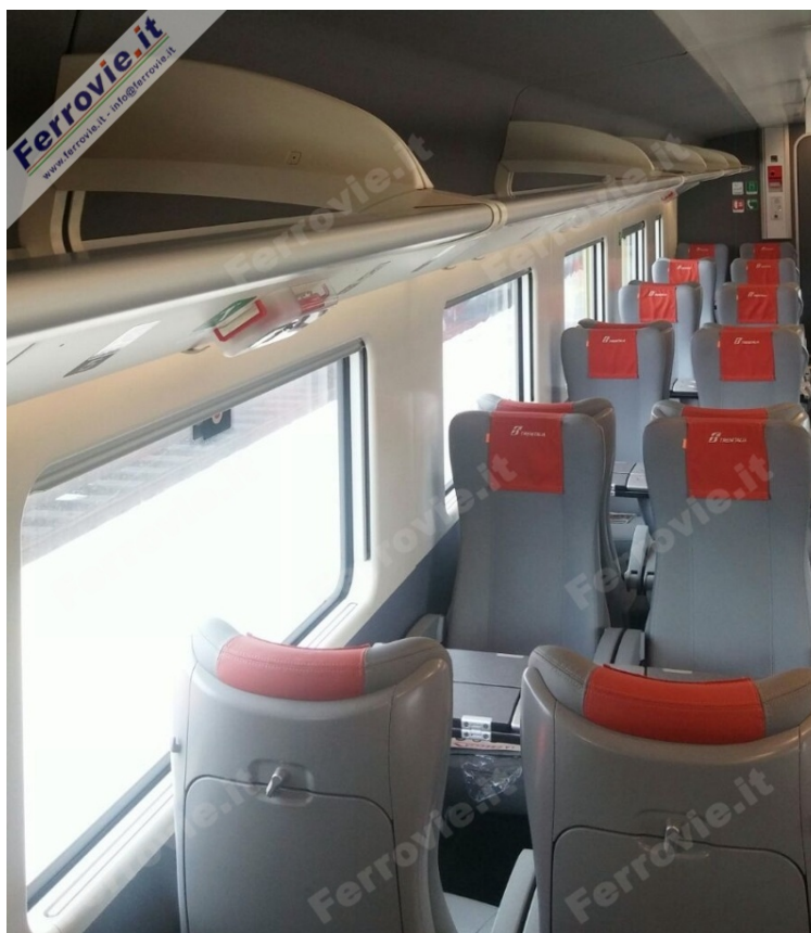
I separatori sulle bagagliere del Frecciarossa 1000, installate in corrispondenza dei montanti.
