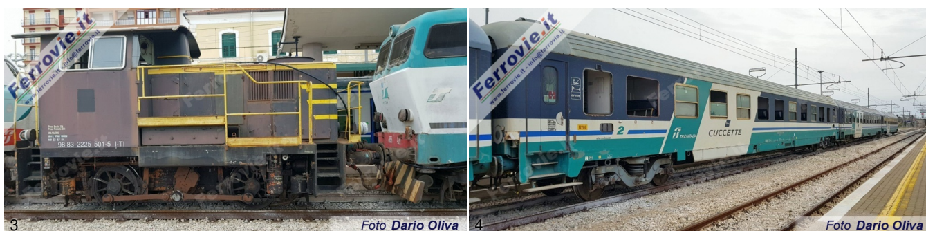
3. Tra la E. 402 e la E.656 era intercalata la locomotiva da manovra 225.5001, esclusa dalla frenatura con un tubo volante che si riconosce per garantire la continuità della condotta passante. (Foto Dario Oliva, 11 aprile 2018)
