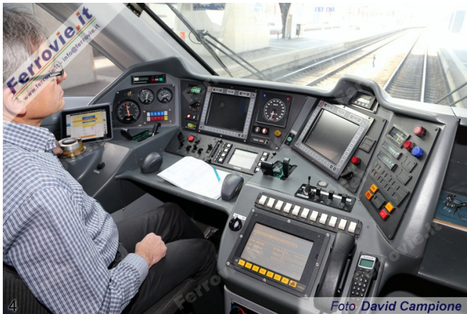
4. Tutto è pronto per la partenza. La velocità è impostata su 25 km/h ed il macchinista attende il consenso dal blocco porte per sfrenare l'ETR.470 e dare trazione. (Foto David Campione, 28 marzo 2015)
