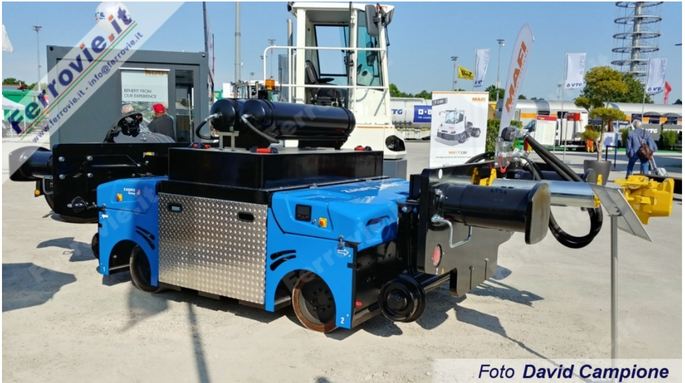
23. Zagro - E-Maxi Vario - Trattore ad accumulatori per la manovra di rotabili ferroviari. (Foto David Campione, 04 giugno 2019)
