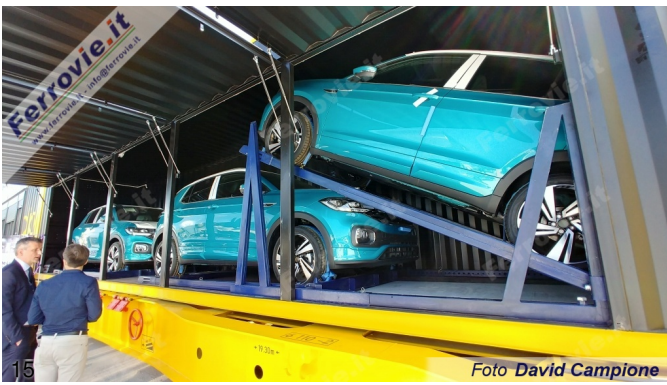
15. Clip - Interno delle casse mobili sul carro della foto precedente, con la soluzione di CFR per il trasporto di auto in ambiente protetto. (Foto David Campione, 04 giugno 2019) 16. SBB Cargo - Il gancio automatico, da alcune settimane impiegato regolarmente da SBB Cargo su alcune composizioni di convogli merci. (Foto David Campione, 04 giugno 2019)
