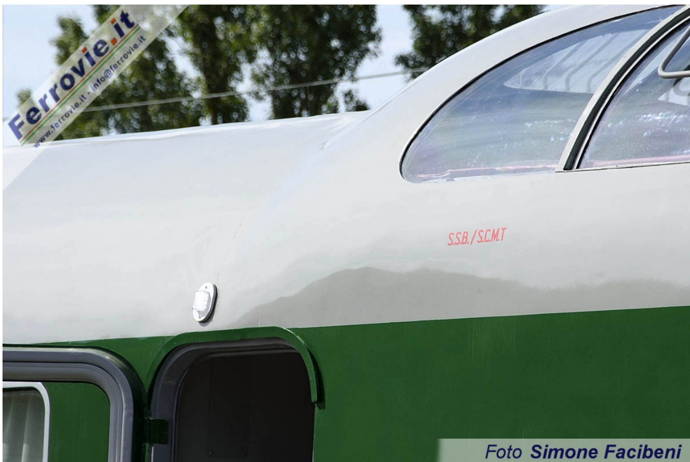
2, Particolare della scritta in rosso, posta al di sotto dei finestrini della cabina rialzata, indicante la presenza a bordo del sistema SCMT e del led bianco relativo al circuito di lateralizzazione e blocco porte. (Foto Simone Facibeni, 21 giugno 2019)
