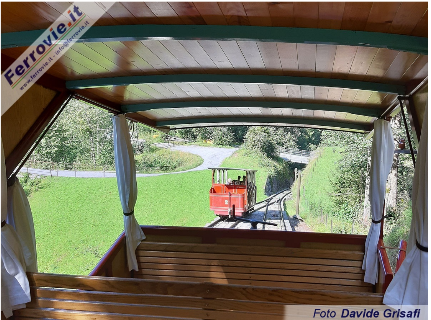
9. Il punto di incrocio della funicolare che porta alle cascate di Reichenbach. A scartamento metrico e lunga 714 metri, supera un dislivello di 244 metri. Le pendenze sono comprese tra il 36,9% e il 57,9%. (Foto Davide Grisafi, 16 agosto 2019)
