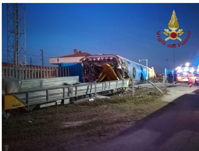
5. La vettura di testa dell'ETR.400 n. 21, sviata per prima e distaccatasi dal resto del convoglio, per poi ribaltarsi presso il fabbricato di servizio. 6. La vettura di coda del treno, sviata sulla massicciata tra il binario di transito e il binario deviato.
