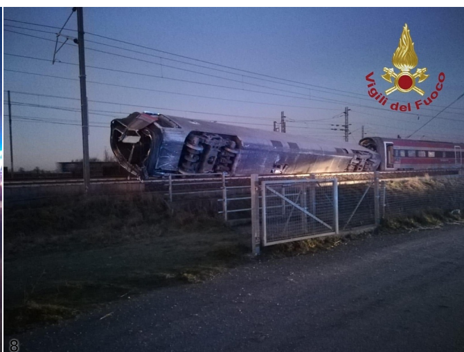
5. La vettura di testa dell'ETR.400 n. 21, sviata per prima e distaccatasi dal resto del convoglio, per poi ribaltarsi presso il fabbricato di servizio. 6. La vettura di coda del treno, sviata sulla massicciata tra il binario di transito e il binario deviato.
