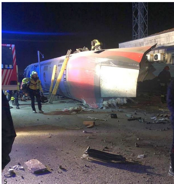
5. La vettura di testa dell'ETR.400 n. 21, sviata per prima e distaccatasi dal resto del convoglio, per poi ribaltarsi presso il fabbricato di servizio. 6. La vettura di coda del treno, sviata sulla massicciata tra il binario di transito e il binario deviato.
